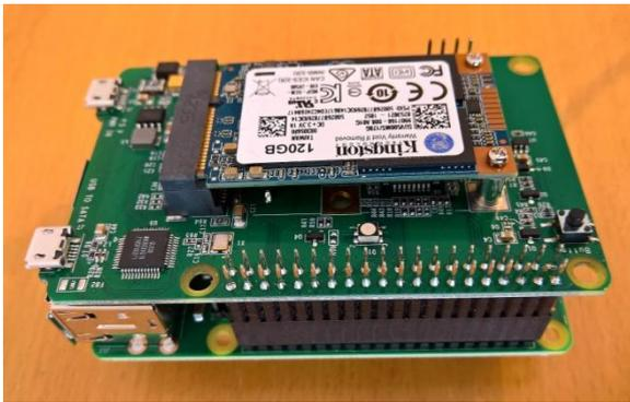
Bevor die beiden Platinen endgültig in das Gehäuse eingebaut werden, steckt man sie für den Test an den Anschlussleisten zusammen. Das sollte mit einem **geraden** sanften Druck geschehen. Dabei darauf achten, dass die Pinne genau passen.
