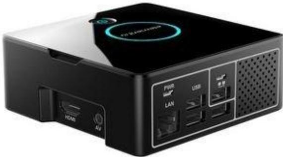
So soll er zum Schluss natürlich aussehen, der neue Kleincomputer. Dazu muss man zuerst wieder den USB-Adapter entfernen und vorsichtig die beiden Platinen voneinander trennen. Als Werkzeug braucht man nur einen kleinen schmalen Schraubendreher.
