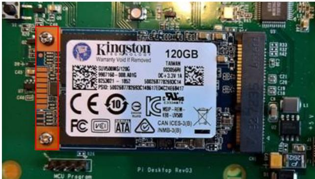
Die mSATA-SSD wird in die mSATA-Schnittstelle der Adapterplatine gesteckt und mit den mitgelieferten zwei kleinen Schrauben befestigt.
